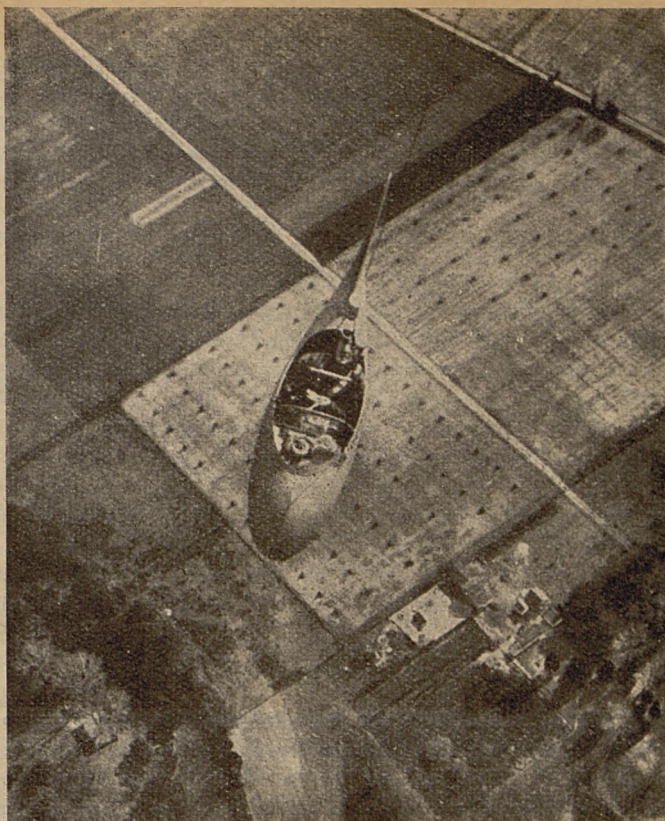
Najnowsza zbobycz amerykańskiego lotnictwa: kabiny obserwacyjne przyłączone na długich stalowych linach do balonu, ukrytego w chmurach przed nieprzyjacielem.
