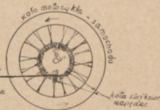
Rys. 2. Przekształcenie ruchu cylindra na obrót kółka
