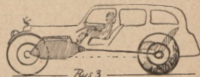
Rys. 3 samochód z umieszczonym motorem na przodzie
