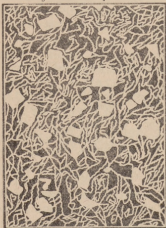
Rys. 1. Stop łożyskowy 78,5% ołowiu. Białe pola — twarde kryształy Pb — Sb, białe igiełki — twarde kryształy Ni — Sb, ciemne tło — miękka podstawa stopu Pb — Sn jako eutoktoit. Powiększenie 150-krotne.
