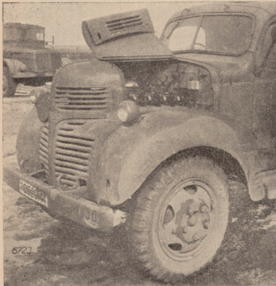
Rys. 8. Wymienny silnik Diesla, wyprodukowany przez „Tatrę“ do tzw. unrowskich samochodów ciężarowych
