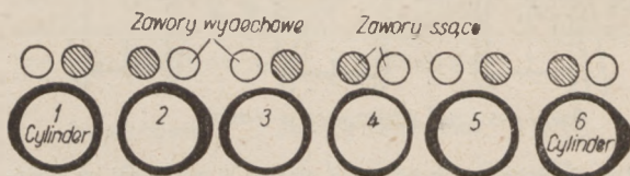
Rys. 3. Zużycie górnej części cylindrów sześciocylindrowego silnika GAZ (beztulejowego) po przebiegu 28 tysięcy km; paliwo — benzyna B-70.
