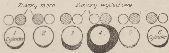
Rys. 8. Zużycie górnej części cylindrów silników GAZ-51: 1, 2, 3, 5 i 6 — cylindry tulejowane; 4 — cylinder nie posiada tulei; przebieg — 13,5 tys. km.
