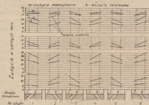
Rys. 2. Zużycie szyjek korbowodowych wałów korbowych silników samochodów „Dodge“ WF—32“
