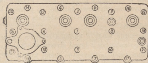
Rys. 8. Kolejność dokręcania nakrętek śrub głowicy silnika.
