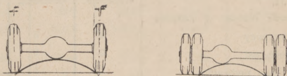
Rys. 4. Pomiar prześwitu poprzecznego
