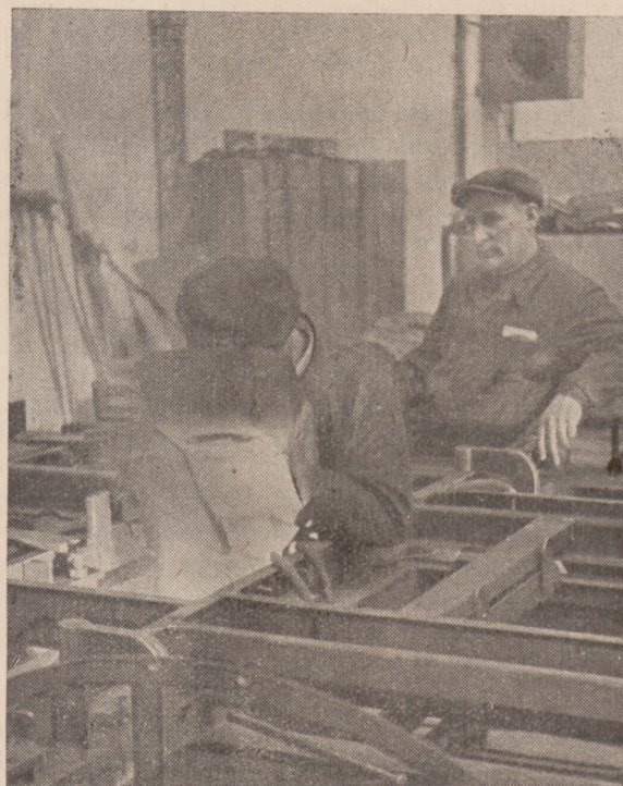
Spawanie ramy samochodu ciężarowego w WZMot.
