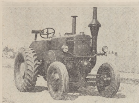
Fot. 14. Ciągnik kołowy rolniczo-drogowy „URSUS“ — C-45
