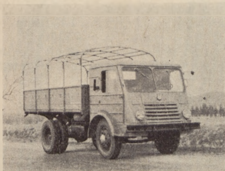
Fot. 1. STAR-20 ze szkieletową budką kierowcy wykonaną z blach głęboko tłoczonych
