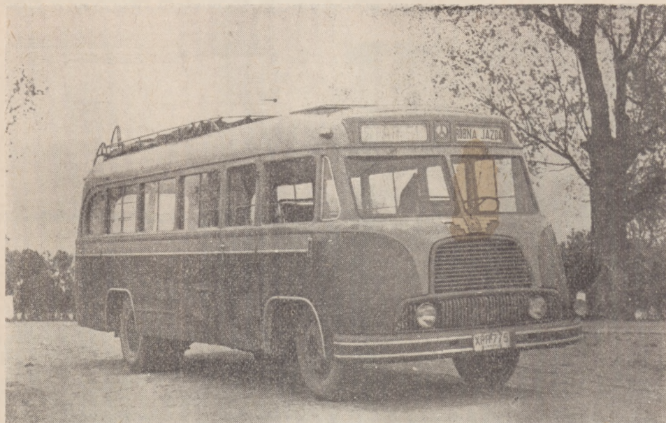
Fot. 9. Osobowo-towarowy autobus STAR-51 z nadwoziem stalowo-drewnianym
