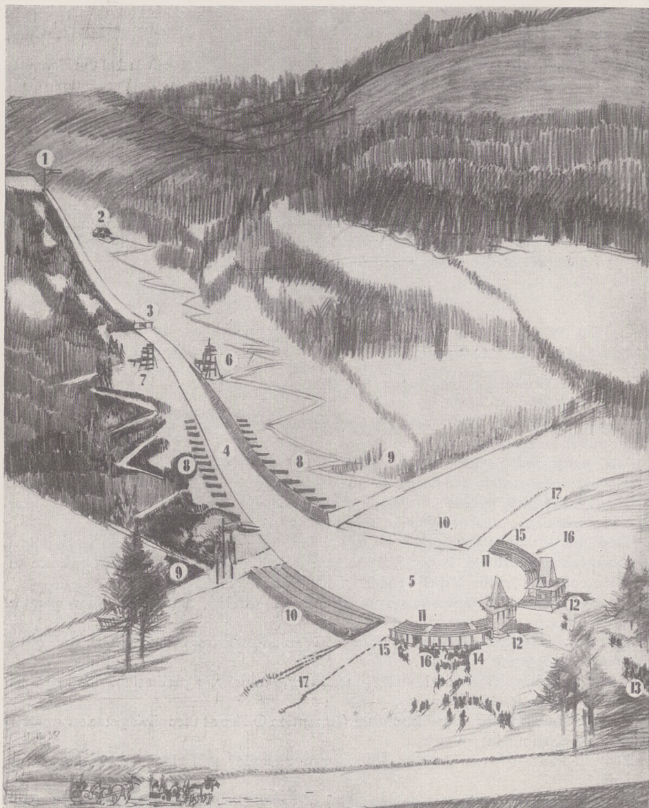
STADION POLSKIEGO ZWIĄZKU NARCIARSKIEGO W ZAKOPANEM U WYŁOTU UL. MARSZAŁKA PIŁSUDSKIEGO: 1) ROZBIEG SKOCZNI. 2) DOM STARTOWY. 3) PRÓG SKOCZNI. 4) ZESKOK. 5) WYBIEG. 6) GŁÓWNA WIEŻA SĘDZIOWSKA. 7) WIEŻA SYGNALIZACYJNA. 8) TRYBUNY BOCZNE (ŁOŻE) NA ZESKOKU. 9) PODEJŚCIE DO STARTU (ŚCIEŻKI). 10) MIEJSCA STOJĄCE. 11) GŁÓWNE TRYBUNY Z MIEJSCAMI SIEDZĄCYMI. 12) PAWILONY REPREZEN- TACYJNE. 13) DOJŚCIE DO STADIONU. 14) STACJA POCZTOWO TELEKOMUNIKACYJNA POD TRYBUNAMI. 15) PRZECHOWALNIA NART POD TRYBUNAMI. 16) BUFETY DLA PUBLICZNOŚCI. 17) TRASY BIEGÓW NARCIARSKICH
