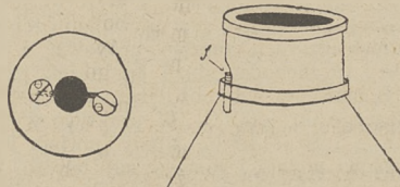
Rys. 5. Z lewej strony — regulowanie gęstości śmietanki przy wirówce „Mélotte“ — lewa strona ustawienie na najgęściejszą śmietankę, prawa — na najrzadszą. Z prawej strony regulowanie gęstości ilości mleka chudego przy pomocy śrubki „S“. (Do art. „Główne zasady obchodzenia się z wirówką“.)
