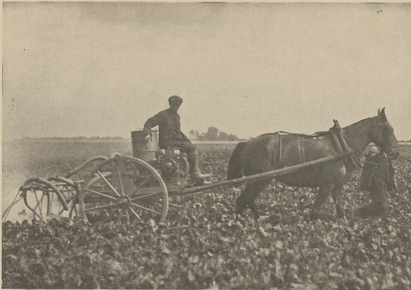
Rys. 2. Opylacz (K. Platz) podczas pracy. Po prawej stronie siedzenia widoczny motor, którego zadaniem jest wytłaczanie sproszkowanych insektycydów z rezerwuaru (Dz. art.: „Metody zwalczania pewnych szkodników buraków cukrowych“)
