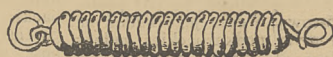
Uczepy sprężynowe czyli siłochrony: u góry siłochron przyrobiony z siłomierza Sacka, u dołu zwykły.
