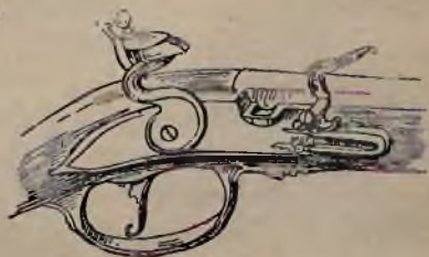
Rys. 5. Zamek skałkowy zachodni.
