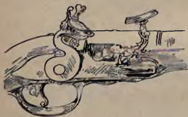
Rys. 4. Zamek skałkowy holenderski.
