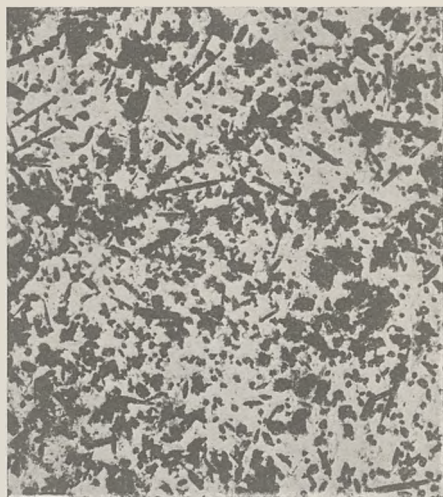
5. Typowy okaz grubodziarnistego cieszyńszynu w naturalnej wielkości (z Dzięgiełowa); szlif. prof. Kazimierza Smulikowskiego.
