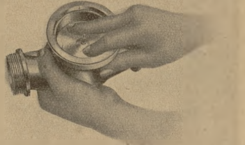
Rys. 3. Regulacja wodomierza »Polskiej Fabryki Wodomierzy i Gazomierzy« w Toruniu.
