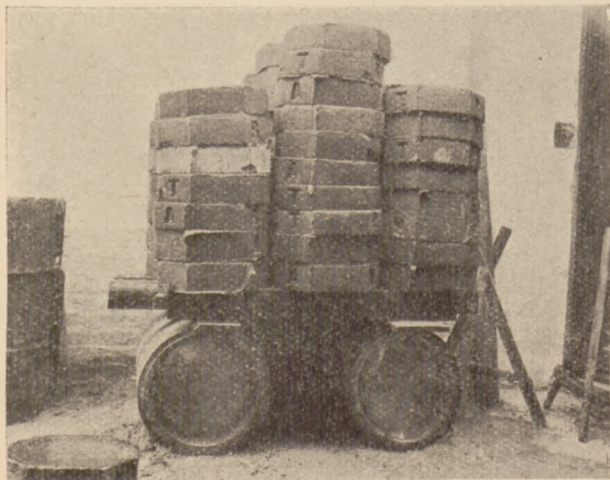
Rys. 3. Próba fabryczna rur kanalizacyjnych \varnothing 400 mm.
