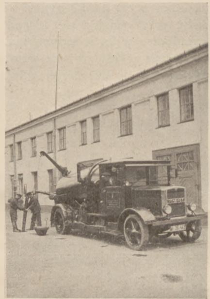
Rys. 15. Spalinowa maszyna do oczyszczania wpustów.
