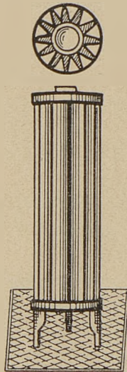
Rys. 14. Piec słupkowy o powierzchni gwiazdziej.
