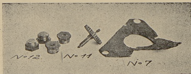
Rys. 3. Płytkę potoczną, kółko zębate i gniazdko prowadzące oś skrzydełka, zniszczone przez korozję.
