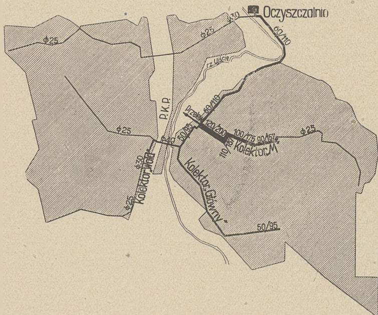
Rys. 11. Kanalizacja m. Równego. — Projekt generalny. — Projekt wykonało w r. 1937 Biuro Projektów Wod. Kan. przy Komisji Reg. Pl. Zab. Wołynia w Łucku.
