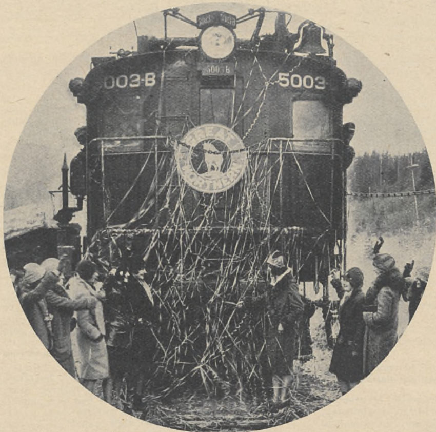
Lokomotywa olbrzym zbudowana przez Great Northern Railway Co., kursująca pomiędzy Seattle i Chicago. Posiada ona 105 stóp długości, bak o pojemności 15.000 galonów wody i 5.000 galonów smaru. Siła jej wynosi 4.000 H. P.
