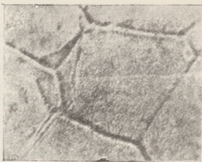
Rys. 2. Martensyt. Hartowana stal o 4,5% C. Pow. 500\times .
