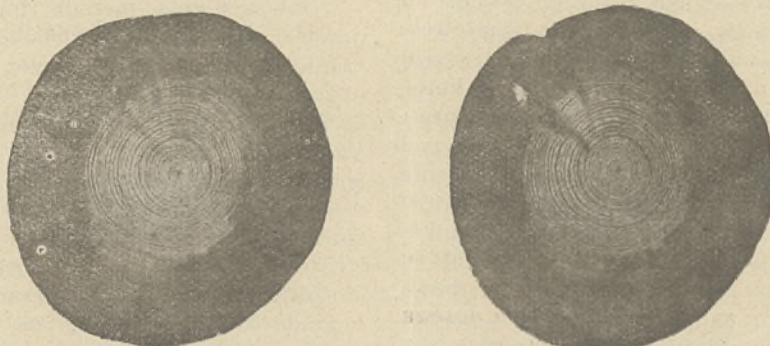
Fig. 6. Przekroje słupów telegraficznych impregnowanych olejem smołowym z węgla kamiennego według sposobu Rüpinga.
