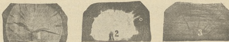
Fig. 5. Przekrój podkładów nasyconych olejem smołowym z węgla kamiennego sposobem Rüpinga.
