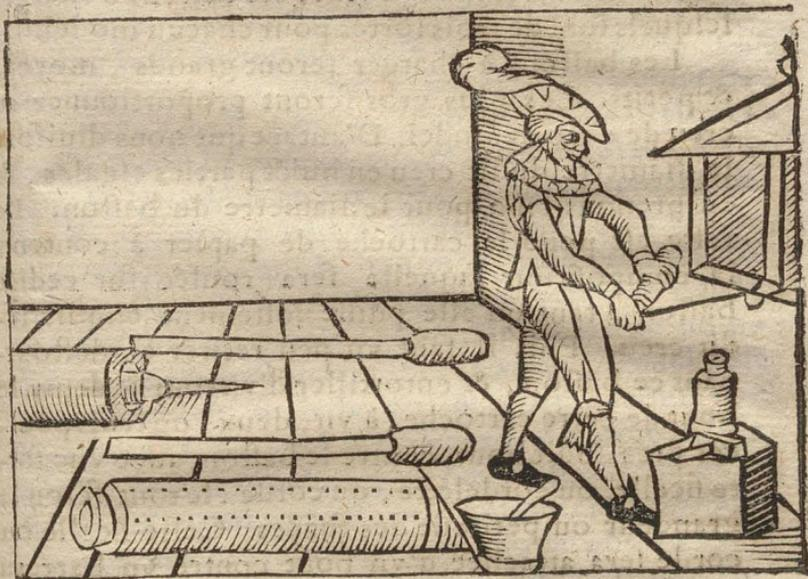
**P**our faire des fuzées plusieurs choses sont necessaire. Il faut les models, les bastons à charger, du papier double bien collé, des ficelles, des baguettes, des poinçons, mortiers, tamis, maillets, & les diuerses compositions dequoy elles sont faites. Les models doiuent estre faits de bois tresfort & solide : Comme buis, fresne, sorbier, ou
