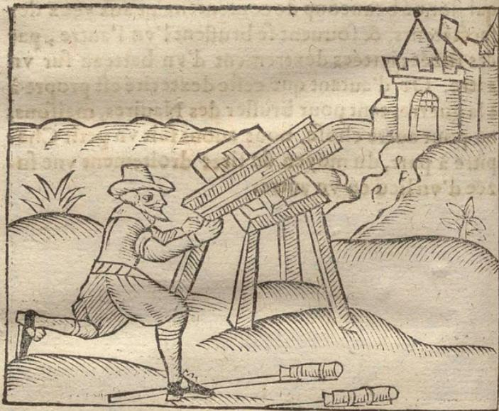
**C**Ecy est propre à vne gageure : Il faut auoir composition de fuzée bien assuree, selon le poids & grosseur que vous luy voulez donner, à fin de ne faillir en vostre entreprise. Disposez vostre dite fuzée, montée avec sa baguette bien proprement, sur vne planche polie, & qui puisse aller en basculant & tournant à vostre volonté, Ainsi que vous
