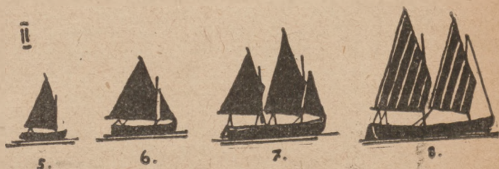
II Typy ożaglowań szalup i dingów.
