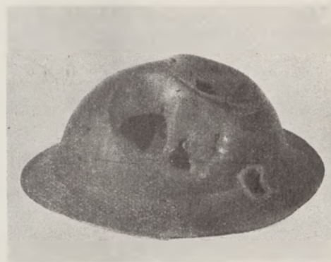
Fig. 10. Uszkodzenia od strzałów na hełmie angielskim.
