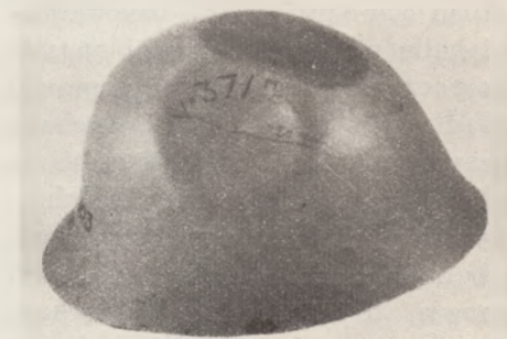
Fig. 13. Uszkodzenia na hełmie szwedzkim z napisami, podającymi warunki strzału.
