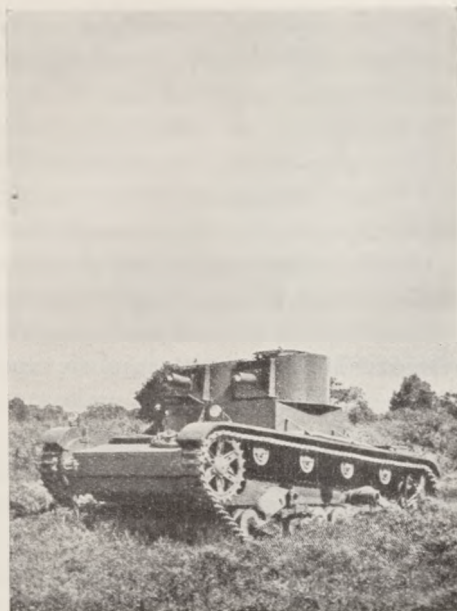
Fig. 2. Czołg syst. Vickers-Armstrong, wyposażony w radjostację Marconi'ego z anteną tyczkową.
