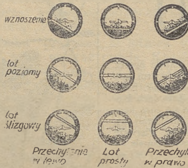
Typowe wskazania sztucznego horyzontu w różnych fazach lotu.
