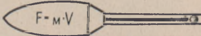
Rys. 1 od góry: Śmigło. Mała różnica prędkości V . Duża masa powietrza M ; napęd strumieniowo-odrzutowy, średnia masa — średnia prędkość; napęd rakietowy, mała masa — duża prędkość
