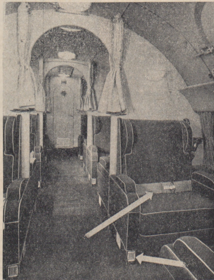
Rys. 3. Wnętrze kabiny pasażerskiej nowoczesnego samolotu komunikacyjnego. Dolna strzałka wskazuje wylot wentylatora, górna — elastyczny pas zabezpieczający.
