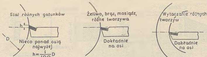
Rys. 4. Ustawienie noża.
