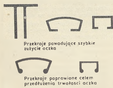
Rys. 10. Przykłady zmiany przekroju celem przedłużenia trwałości matrycy do wyciskania.
