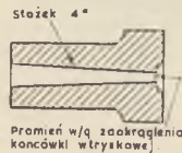
Rys. 25. Gardziel dla form wtryskowych.
