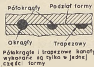
Rys. 27. Kształt kanałów rozprowadzających.
