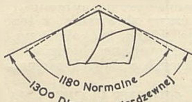
Rys. 7. Kąt wierzchołkowy dla wiercenia płytkich otworów.
