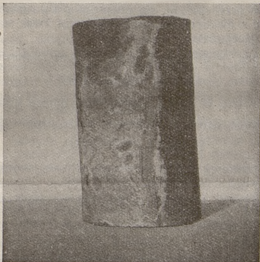
Rys. 3. Siarczany żelaza skupione na powierzchni tej płomieniówki usunięte zostały za pomocą spłukania ich wodą. Należy zwrócić uwagę na ostre linie w miejscach gdzie powstawały produkty rozkładu.
