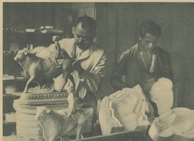
Die der Form entnommene Figur wird zusammengesetzt
