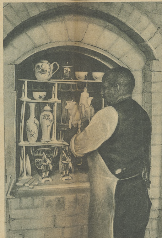
Der Brennofen. — Durch das Brennen wird die Figur um etwa ein Drittel kleiner
