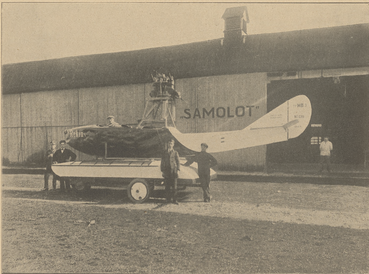
Rys. 97. Ślizowiec polski inż. M. Bogatyrewa. (Długość 4.50 m., szerokość 1 m. 20, waga 500 kg. Silnik 80 km. „Argus“. Nośność 4 osoby. Zanurzenie 5 cm.).
