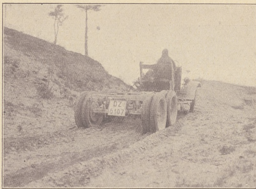
Próba terenowa podwozia sześciokołowego.
