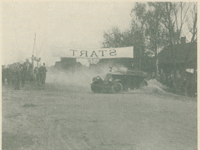
Sensacyjna próba wytrzymałości pneumatyków Michelin urządzona była w Strudze pod Warszawą. Samochód, jadący pełnym gazem na nienapompowanej oponie, zawrócił nagle o 180°, przyczem pneumatyk nie spadł z obręczy.
