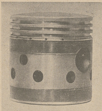
Rys. 3. Tłok aluminiowy z żeliwnymi obręczkami (Fiat 501).
