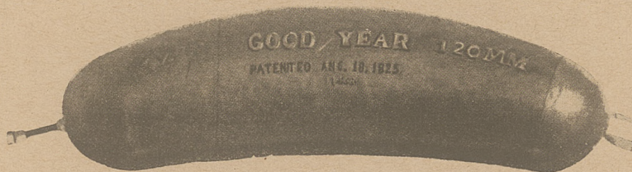
Worek gumowy, wywierający ciśnienie wewnętrzne na opony podczas naprawy.
