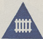
Przejazd kolejowy zabezpieczony (rampa)
