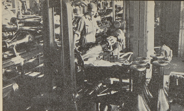
Rys. 12. Wiercenie otworów w kołnierzu pochwy.
