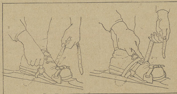
Po przewleczeniu przez kółko, przewija się taśmę spodem podeszwy na drugą stronę buta, okręca go po wierzchu buta i pod podeszwą wraca do sprzączki, na którą zapina się ostecznie.
