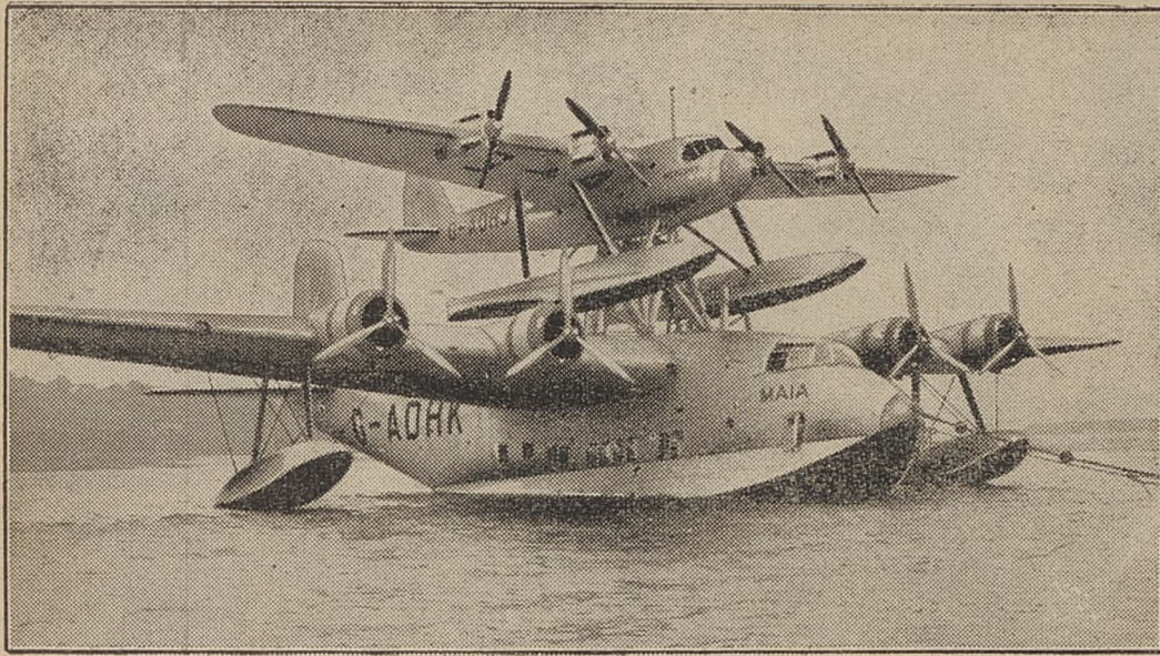
W Anglii zbudowano olbrzyma powietrznego, z którego przy pomocy odpowiedniego urządzenia mogą startować mniejsze hydroplany.
