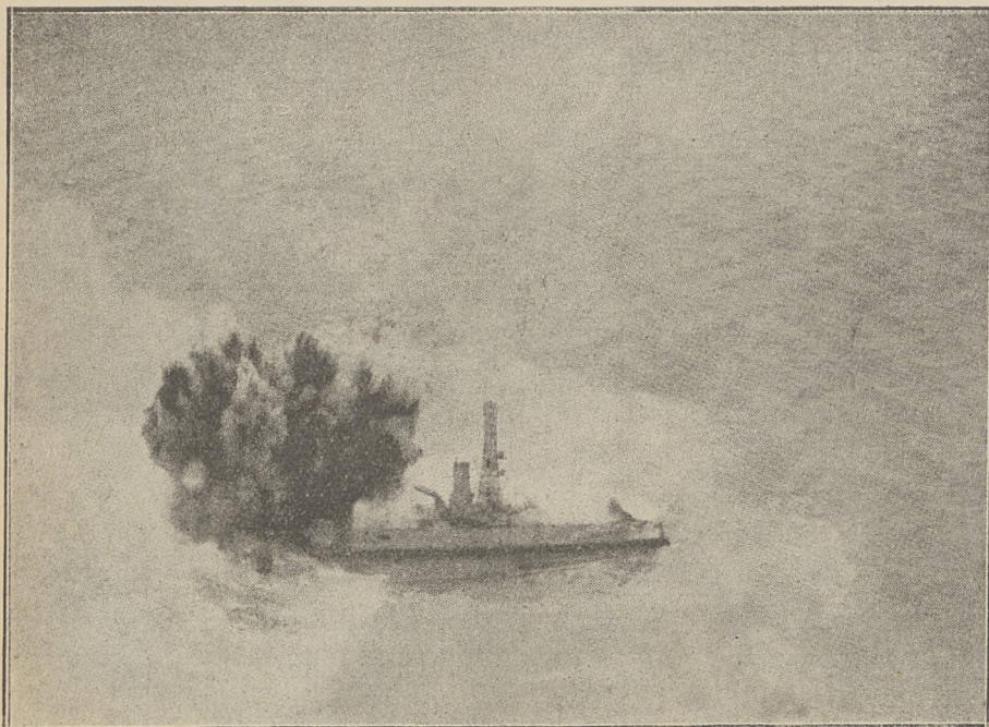
Z manewrów lotniczych armji Stanów Zjednoczonych. Bomba lotnicza trafiła w okręt wojenny. Po zbadaniu przekonano się, że wybiła ona otwór szerokości 28 stóp i długości 48 stóp. Okręt zatonął w ciągu 20 sekund. (Aeronautics).
