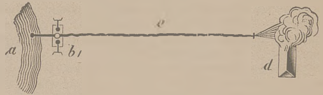
Rys. 2. Ustawienie sikawki bezpośrednio przy zbiorniku wody: a — zbiornik wodny, b — sikawka, e — linja węzowa, d — palący się budynek.
