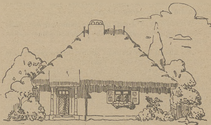
Wygląd budynku, składającego się z jednej izby, komory i sieni. Strzecha słomiana, nasycana gliną (Plan w Nr. 3-im Przeglądu Poż. , str. 58, rys. 8).
