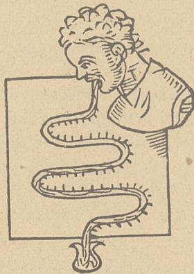
Termometr powietrzny podług Santortia ; kuliste zakończenie wkłada się do ust, płaski koniec kładzie się na okolicę serca
